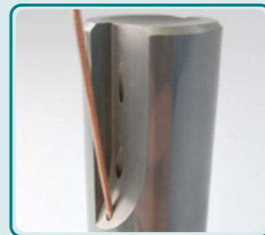
foratura con un angolo di ca. 10° drilling hole with an angle of approx. 10°
