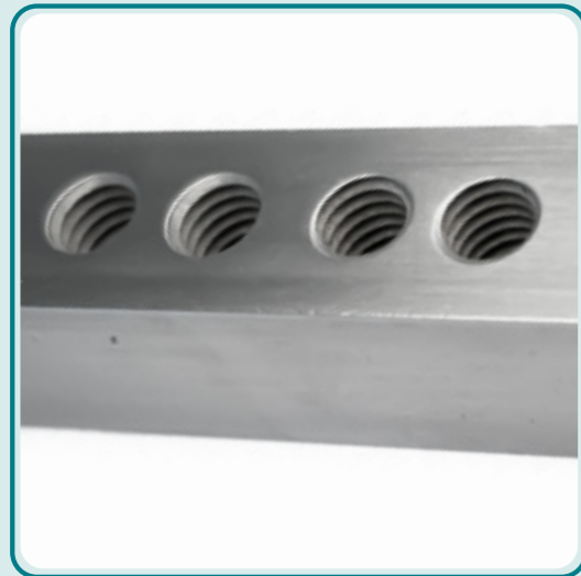
filettatura su metallo duro carbide thread
