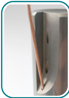
sehr schräge Bohrungen z.B Kühlbohrungen holes on an angle e.g. cooling holes
